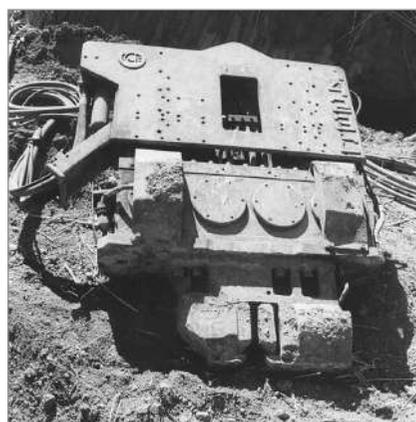
Figura 7.12 Martelo vibratório
