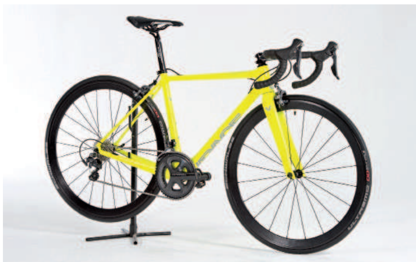
Bicicleta de corrida com selim estreito, guiador de competição e aros aerodinâmicos de alto perfil.
